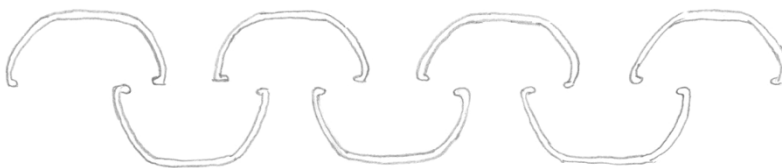
Prallblech-Abscheider mit Profilen in U-Form
