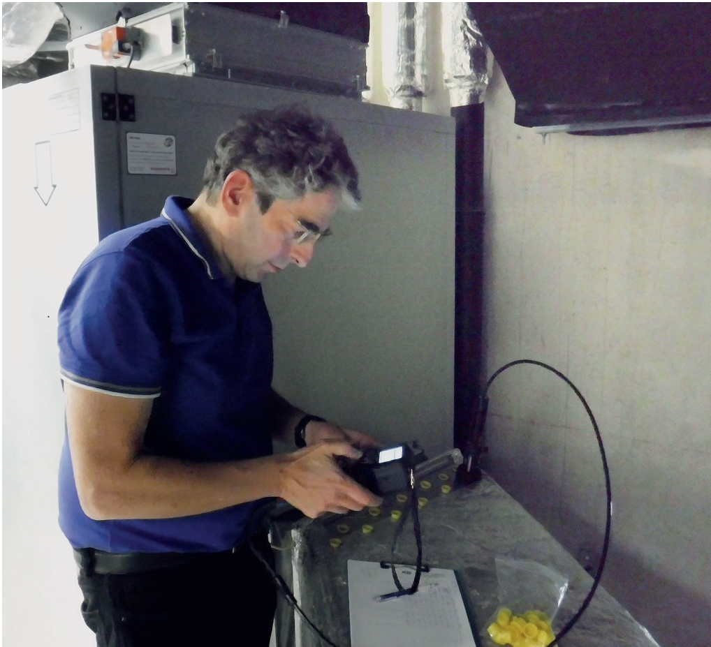
Abbildung II-7-4: Messung des Küchenabluftvolumenstroms an einer ungünstigen Stelle
