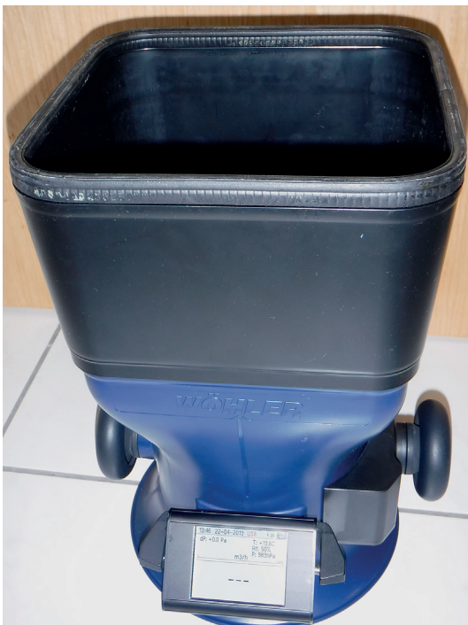
Abbildung II-7-6: Strömungsmessgerät mit Druckkompensation und Messtrichter
